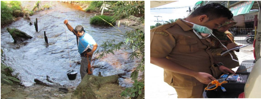
Gambar 2.1 Pengambilan sampel dan uji insitu sampel air sungai
