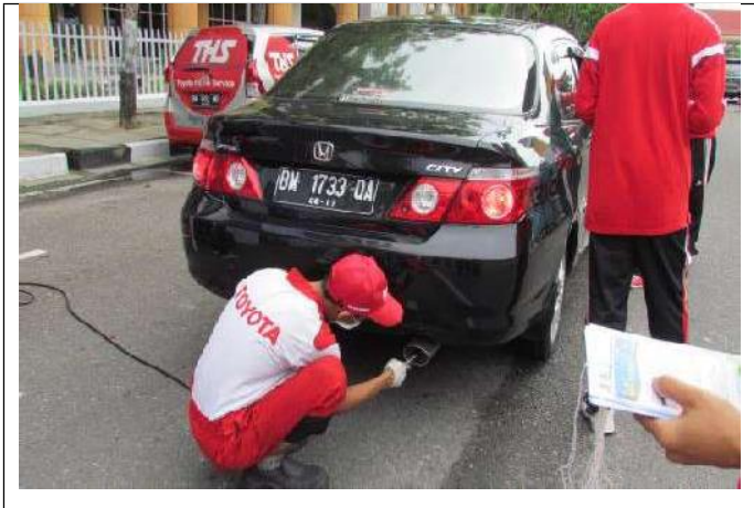
2.4 Gambar Uji Emisi Kendaraan Bermotor (Sumber Bergerak)
